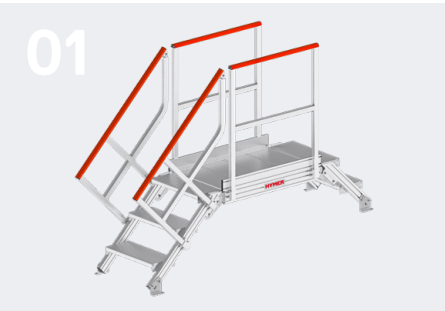
Beispiel mit Breite 600 mm und Aluminium gerieft R11; 45°; asymmetrische Höhen; Handlauf nur an einer Treppe
