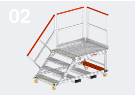
Beispiel mit Breite 1.000 mm und Stahl-Gitterrost R13; 60°; Handlauf einseitig; Staplertaschen; Fußbremse
